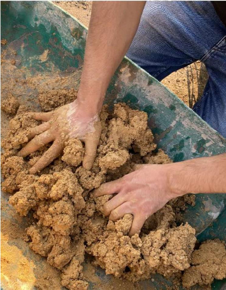
Antes de proceder con la construcción del muro, se llevan a cabo pruebas esenciales para la identificación de la tierra que se utilizará en el proceso. Estas pruebas incluyen la prueba del churro, la botella, la pastilla y el lavado de manos.
